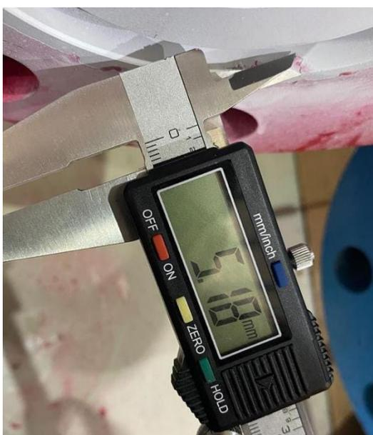
Gambar 3. Indikasi cacat pada gate valve
