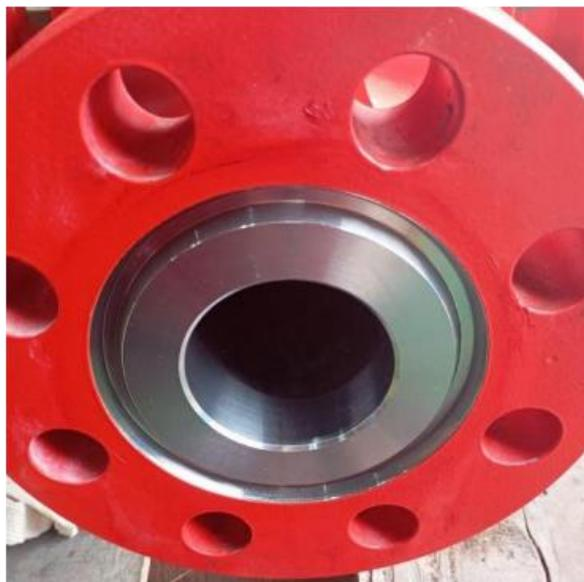
Gambar 1. Ring groove sebelum dilakukan penetrant Testing
