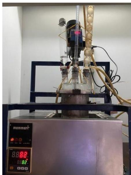
Gambar 1. Proses melarutkan polivinyl alkohol dalam pelarut
