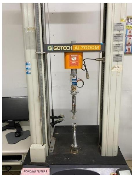
Gambar 5. Pengujian kuat tarik sampel polivinyl asetat
