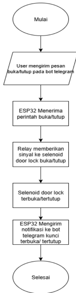
Gambar 3. Flowchart Proses Buka Kunci Solenoid melalui Telegram
