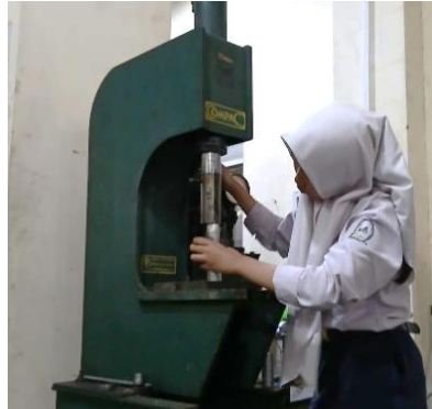
Gambar 1. Proses pencetakan biokokas menggunakan mesin press Leybold-Heraeus Compact MDP 10-1 dengan tekanan sebesar 2 ton metrik ( \pm 20 kN).
