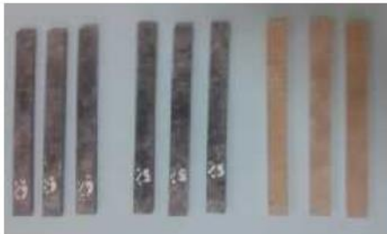
Gambar 2. Spesimen uji MOR sesuai ASTM D790-03
