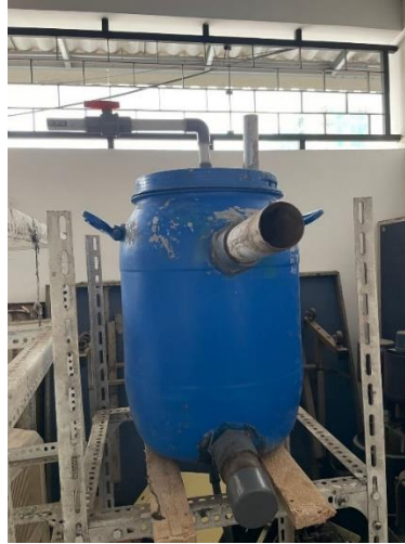
Gambar 1. Reaktor Kontinyu untuk Proses Pembentukan Biogas
