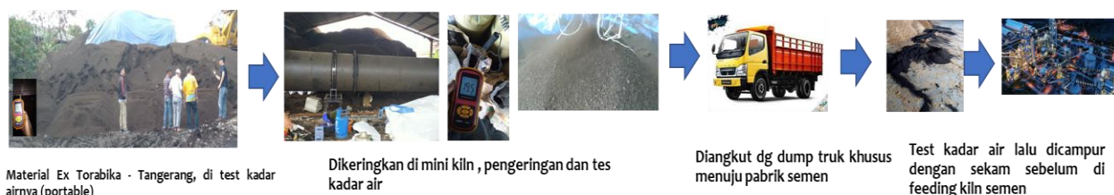
Gambar 6. Proses pengolahan limbah ampas kopi sampai dengan pemakaian limbah ini menjadi bahan bakar di industri semen
