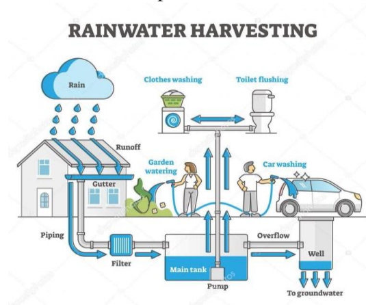
Gambar 1. Ilustrasi Sistem Pemanenan Air Hujan ( Rainwater Harvesting ) [17].
